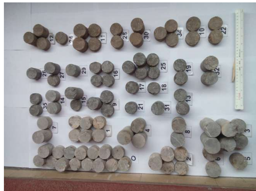
Izgled jezgra nakon brušenja i poliranja spremnog za ispitivanje u laboratorijskim uslovima
