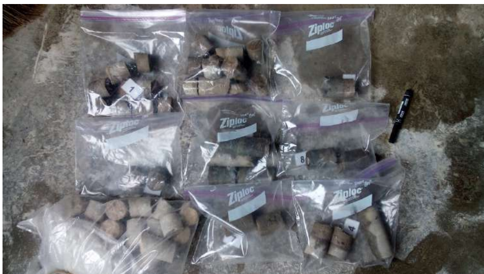
Izgled izvađenog jezgra spakovanog u odgovarajuće plastične kese; pre ispitivanja u laboratorijskim uslovima potrebno je izbrušiti gornju i donju osnovu
