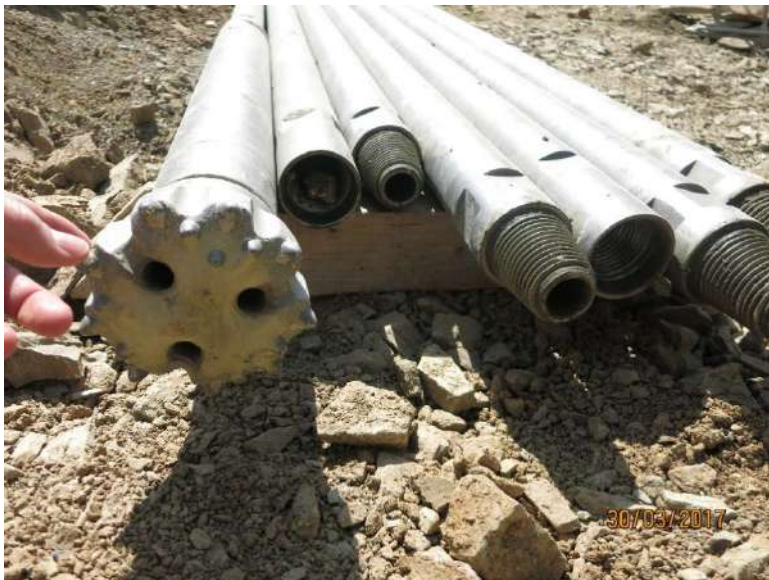
Izgled krune (dleta) kao sastavnog dela ankera, tzv. samobušajući anker (Predejane, Grdelica)
