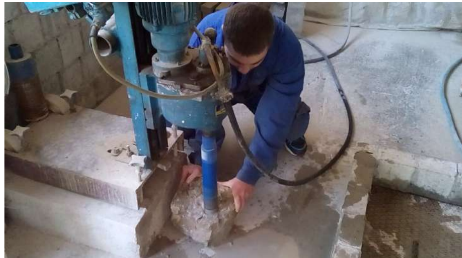
Bušilica u radu i blok stene iz koga se jezgru
