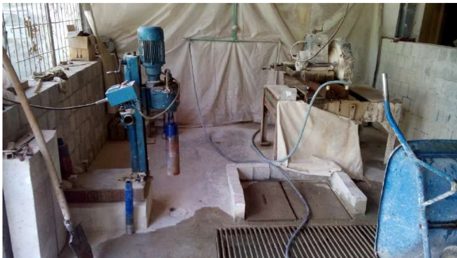
Izgled ručne bušilice za vađenje kernova betona i stene (laboratorija Instituta IMS iz Beograda)
