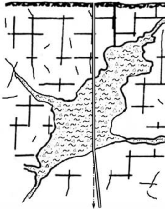
Skretanje bušotine na kontaktu sredina različite tvrdoće
